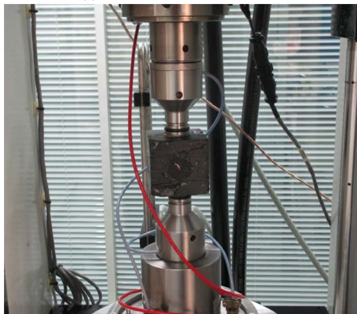
(c) 集成纵、横波双探头的耐高温压的压头
