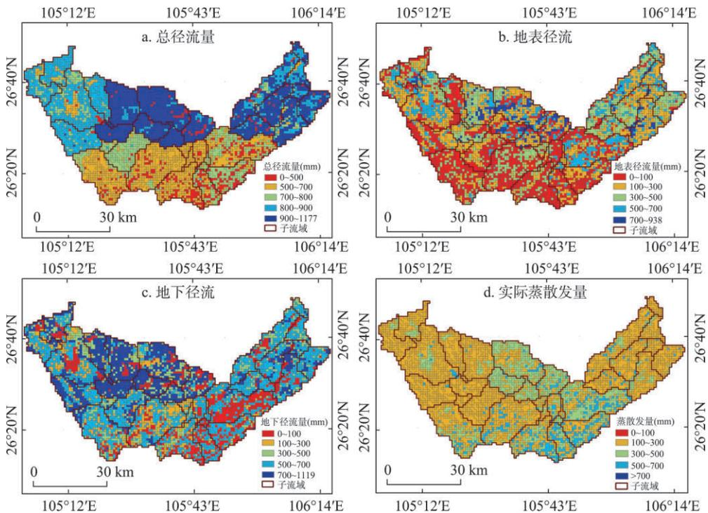
图4 三岔河流域总流量、地表径流、地下径流及实际蒸散发量的空间分布格局
