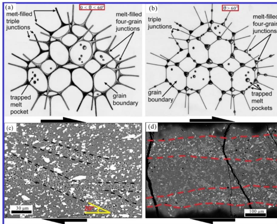
图6 (a) 部分熔融岩石中二面角 $0^\circ < \theta < 60^\circ$ (据 Kohlstedt, 2002) (b) 二面角 $\theta > 60^\circ$ (据 Kohlstedt, 2002) (c) 橄榄石+MORB 熔体简单剪切(据 Holtzman *et al.*, 2007) (d) 橄榄石+2%(vol.) MORB 熔体简单剪切(据 Zhang *et al.*, 2014); 图(c)和(d)中虚线区域代表富集熔体带状区域
