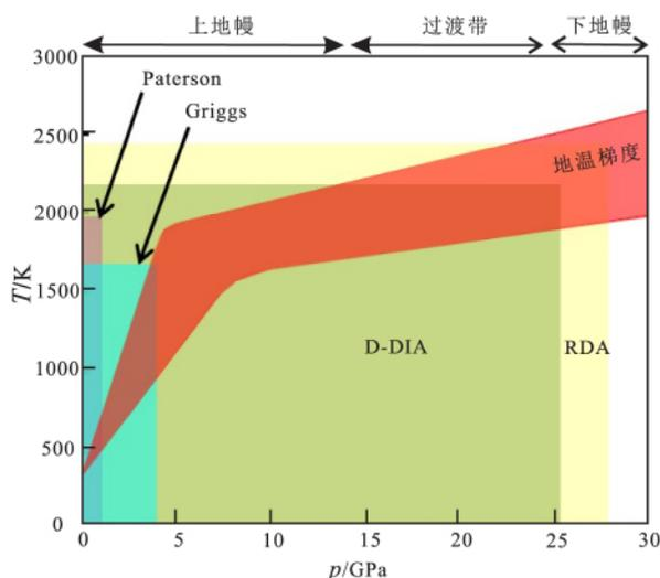
图 3 不同类型变形实验设备所能够产生的温压条件
