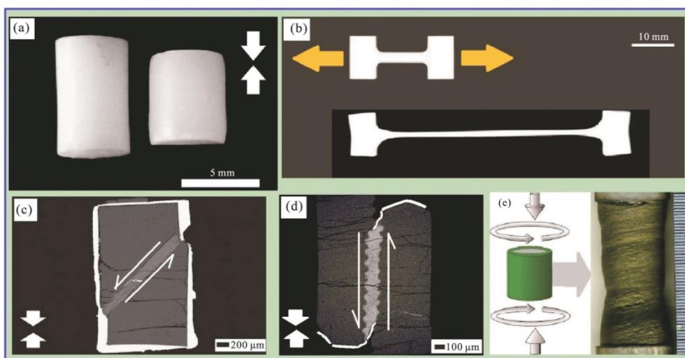
(a) 纯剪切-压缩(据 Tasak *et al.*, 2013); (b) 纯剪切-拉伸(修改自 Miyazaki *et al.*, 2013); (c) 简单剪切 1°~45°切角(据 Ohuchi *et al.*, 2011); (d) 简单剪切 2°~90°切角(据 Zhang *et al.*, 2014); (e) 简单剪切 3-扭转变形(修改自 Hansen *et al.*, 2012)
