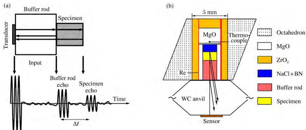
图3 超声干涉法测量示意图<sup>[191-192]</sup>((a)常压;(b)高压)
