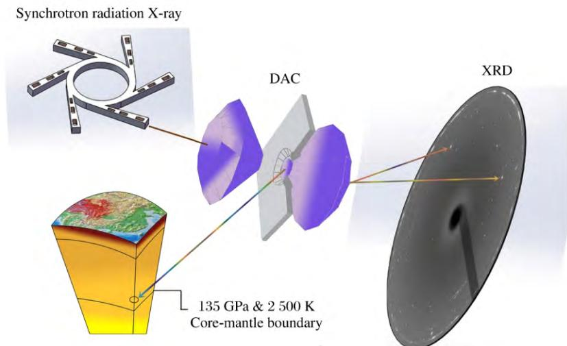
图 1 同步辐射 XRD 与激光加温 DAC 技术相结合探测地幔深部的矿物相变及其物理化学性质
