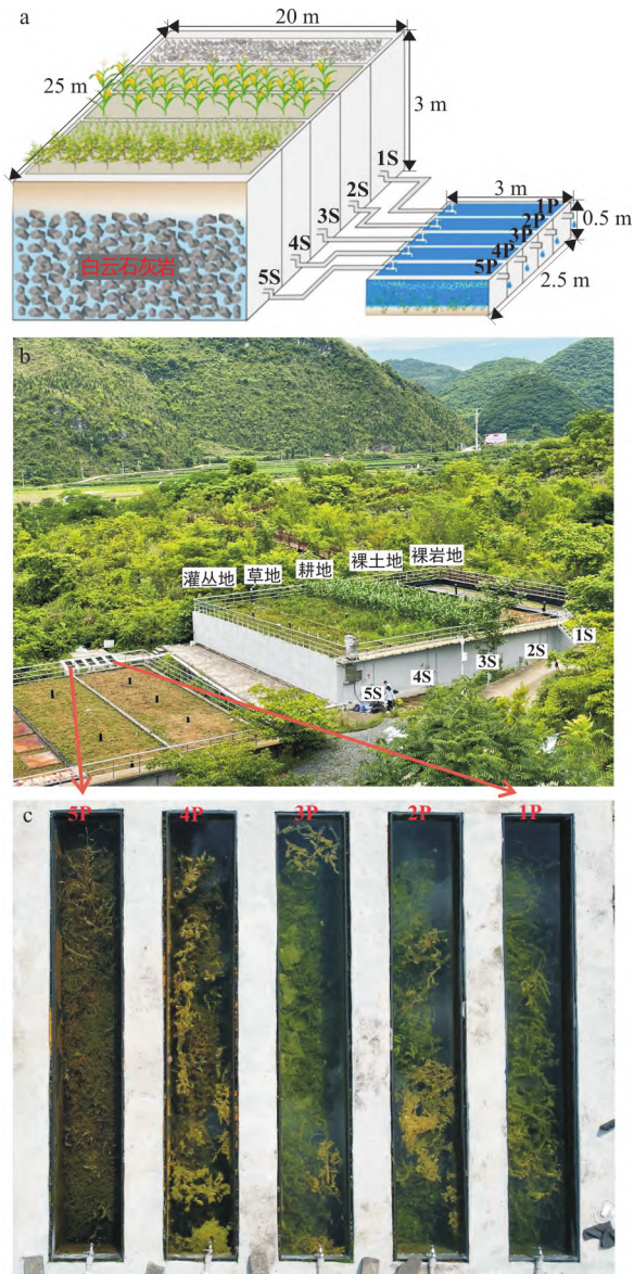
a. 试验场示意图(S和P分别代表泉水和水池); b. 试验场全景图; c. 1P~5P分别代表了裸岩地、裸土地、耕地、草地和灌丛地5种不同的土地利用类型所对应的池水
