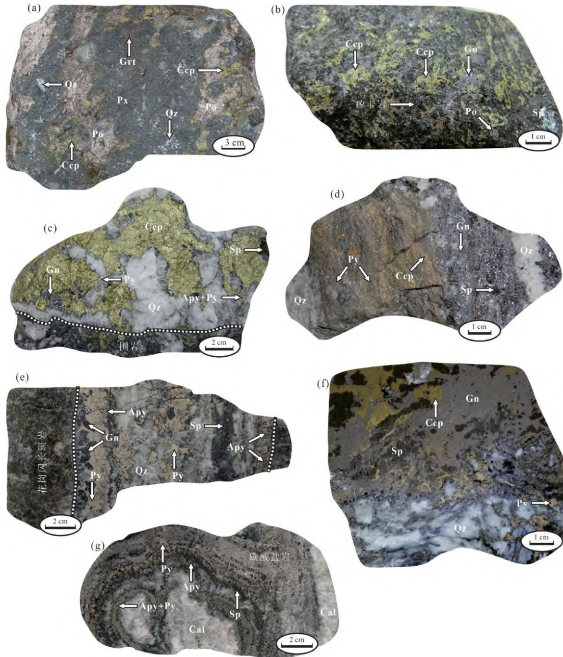
(a)近端内砂卡岩矿石,矿石矿物主要为黄铜矿和磁黄铁矿;(b)近端外砂卡岩矿石,矿石矿物主要为黄铜矿、闪锌矿、方铅矿、磁黄铁矿和黄铁矿;(c)铜硫化物-石英脉矿石,矿石矿物主要为黄铜矿、黄铁矿和毒砂,其次为闪锌矿和方铅矿;(d)铜铅锌硫化物-石英脉矿石,矿石矿物主要为黄铜矿、闪锌矿、方铅矿和黄铁矿;(e)铅锌硫化物-石英脉矿石,矿石矿物为闪锌矿、方铅矿、黄铁矿和毒砂;(f)远端砂卡岩矿石,矿石矿物主要为黄铜矿、闪锌矿、方铅矿和黄铁矿;(g)碳酸盐交代型矿石,矿石矿物为闪锌矿、方铅矿、黄铁矿和毒砂
