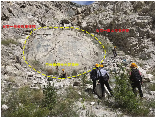
图6 可可托海3号脉坑底出露的侵入于石英-白云母巢状体带(IV带)中的白云母钠长石花岗岩
