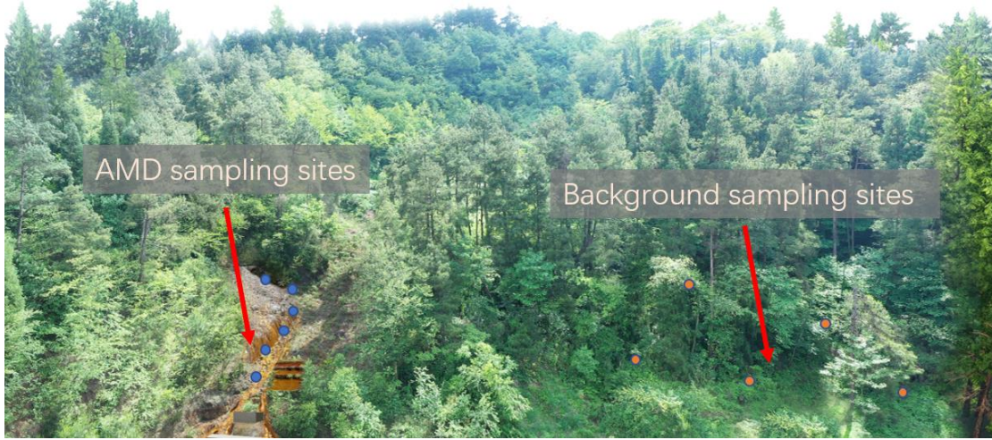
图 6. 土壤样品采样点信息。6 个 AMD 污染土壤样品收集于 AMD 流过的坡道，5 个背景样品收集于周边未受 AMD 明显影响的林地土壤。
