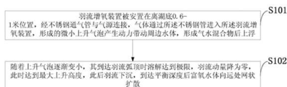
1. 一种气泡羽流扩散增氧深水湖泊水质修复方法,其特征在于,所述气泡羽流扩散增氧深水湖泊水质修复方法采用水体分层期间在湖底安置羽流增氧喷射装置,羽流增氧喷射装置气源为纯氧,羽流增氧喷射装置中喷射出的气泡与引入水流形成气水混合物后上升,随着气泡不断溶解、消失,气水混合物上升至热分层前到达最大高度,因密度差异会形成下沉羽流,羽流下沉至平衡深度后富氧水体向四周扩散并进入远处水体环境中,给湖下层直接增氧,气水混合物上升流速为0.12m/s-0.17m/s;增氧过程在温跃层以下完成,上升羽流不会扰动水体热分层;对所述羽流增氧装置喷射出的原始上升气泡形成的原始气泡半径小于3mm,
