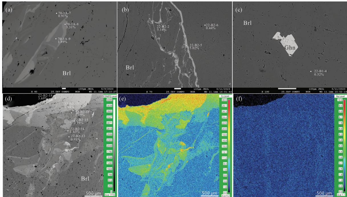
图 6 冲乎尔萨尔加克 1 号伟晶岩绿柱石的 BSE 成像特征和碱金属元素面扫描
