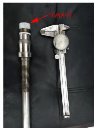
图 3 样品密封图 Fig. 3. Diagram for sample seal.
