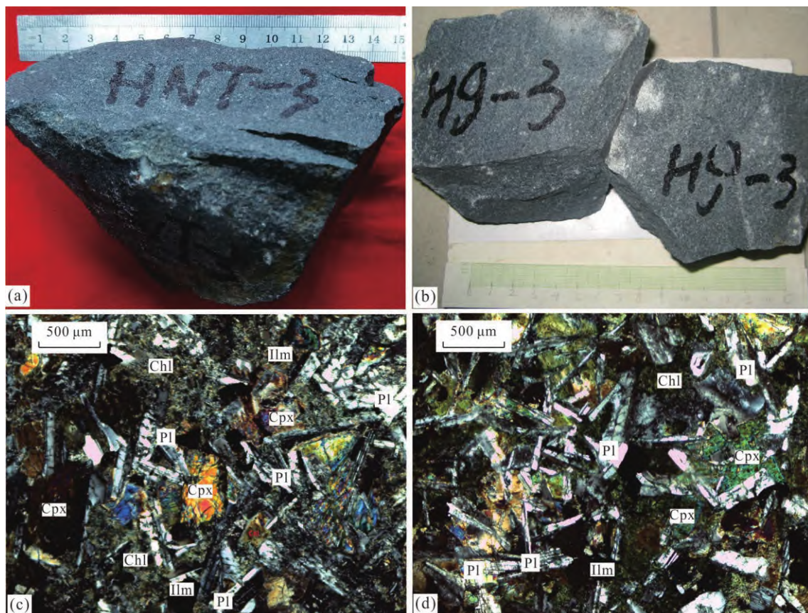
图2 闽西南基性岩墙标本与镜下正交偏光照片
