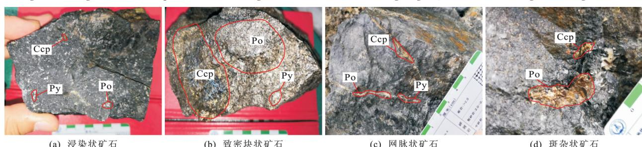
Po 为磁黄铁矿;Py 为黄铁矿;Ccp 为黄铜矿
