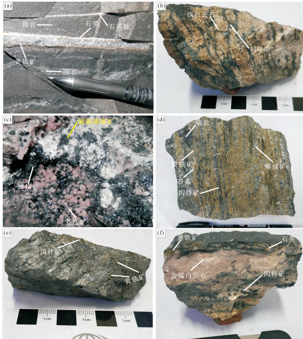
(a) 石英与金属矿物呈细脉充填于围岩裂隙中; (b) 网状状闪锌矿穿插含铁白云石; (c) 菱锰矿晶洞中充填毛状脆硫锑铅矿、板状辉锑矿; (d) 条带状黄铁矿、石英、闪锌矿, 含有少量辉锑矿; (e) 致密块状矿石中分布着零星的黄铁矿; (f) 黑色粒状闪锌矿被含锰白云石胶结, 呈角砾状构造
