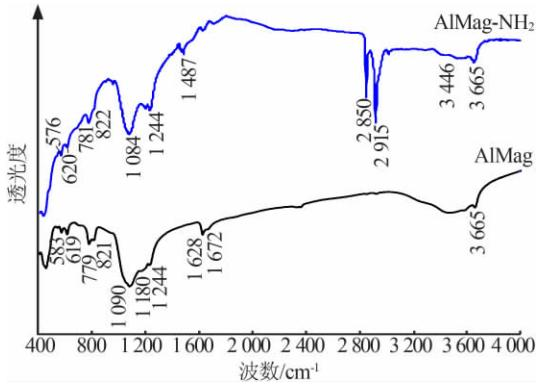
图 2 AlMag 和 AlMag-NH<sub>2</sub> 的红外光谱图
