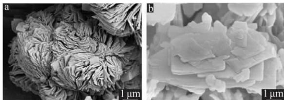
图 3 AlMag(a) 和 AlMag-NH<sub>2</sub>(b) 的 SEM 照片
