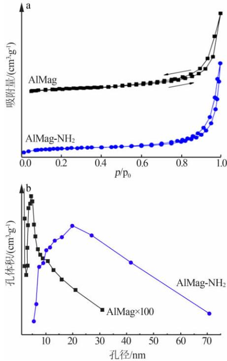
图 4 AlMag 和 AlMag-NH<sub>2</sub> 的氮气吸-脱附等温线和孔径分布曲线
