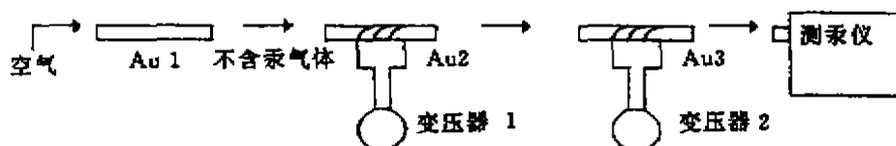
Au1: 用于除去空气中汞的捕汞管; Au2: 采样用的捕汞管; Au3: 专供分析用的捕汞管
