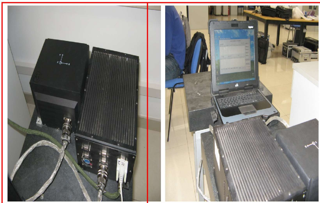
图 4-5 大理石测试台及 IMU 安装图
