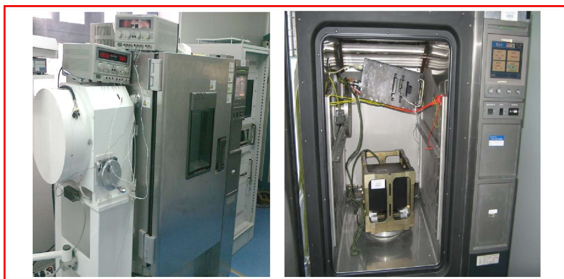
图 4-1 温控单轴速率转台及 IMU 安装图
