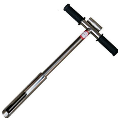
图 5.23 不锈钢取土钻（钻头直径 38 mm，钻头长度 25 cm）
