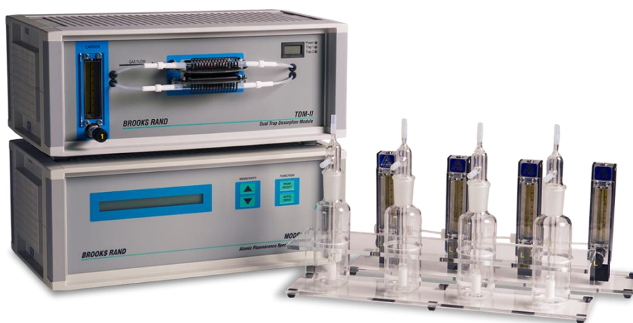
图 5.29 Brooks Rand Model III 冷原子吸收测汞仪（手动总汞分析系统）
