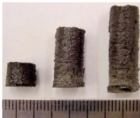
图 5 基于激光近形制造技术打印的不同高度的模拟月壤圆柱体<sup>[22]</sup>
