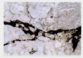
照片 8 GZ 01 -15-6 变余砂岩(平秋),实验后矿物颗粒圆滑,不规则裂隙发育,金硫化物(黑色)活化、迁移聚集充填在裂隙中。×30(-)
