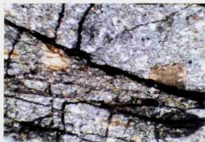
照片 6 BKS-2 铁白云石化板岩(八克),实验后裂隙明显,并切穿矿物,多为不规则交叉裂隙。×30(+)
