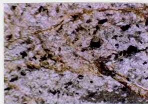
照片 4 GZ 01 -25-5 变余砂岩(同古),实验后发育共轭 X 剪切裂隙。×30(-)
