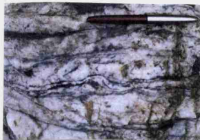
照片 13 平秋镇红鑫金矿含金石英脉呈塑性流动状态沿顺层及穿层裂隙充填。(野外照片)
