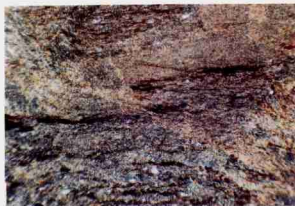
照片 2 GZ 01 -21-1 粉砂质板岩(平秋),实验后呈弱塑性变形,发育不太明显的隐裂隙。×30(+)
