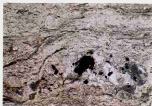
照片 16 GZ04-21-4 变余砂质板岩(平秋红鑫金矿) 实验后塑性变形形成褶曲, 含金硫化物和石英脉沿褶曲轴部充填。
