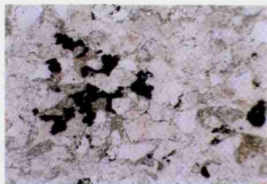
照片 7 GZ 01 -15 (1) 变余砂岩(平秋),实验前矿物颗粒大小均匀,具棱角状,硫化物(黑色)星散分布无明显变形。×30(-)
