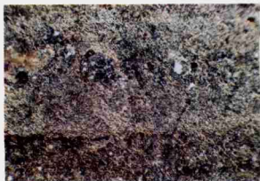
照片 1 GZ 01 -21 粉砂质板岩(平秋),实验前矿物颗粒粗细相间成条带状,无明显变形。×30(+)
