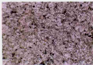
照片 3 GZ 01 -25 变余砂岩(同古),实验前矿物颗粒较细,大小均匀,无明显变形。×30(-)
