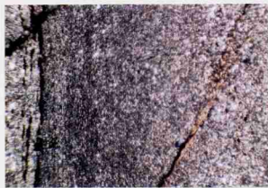
照片10 GZ 02 -12-2 粉砂质板岩(同古),实验后发育顺层和穿层裂隙,金硫化物(黑色)沿裂隙充填。
