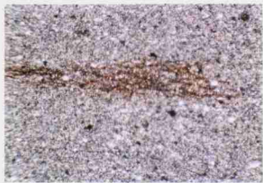
照片9 GZ 02 -12 粉砂质板岩(同古),实验前矿物颗粒细小,均匀,无明显变形。×30(+)
