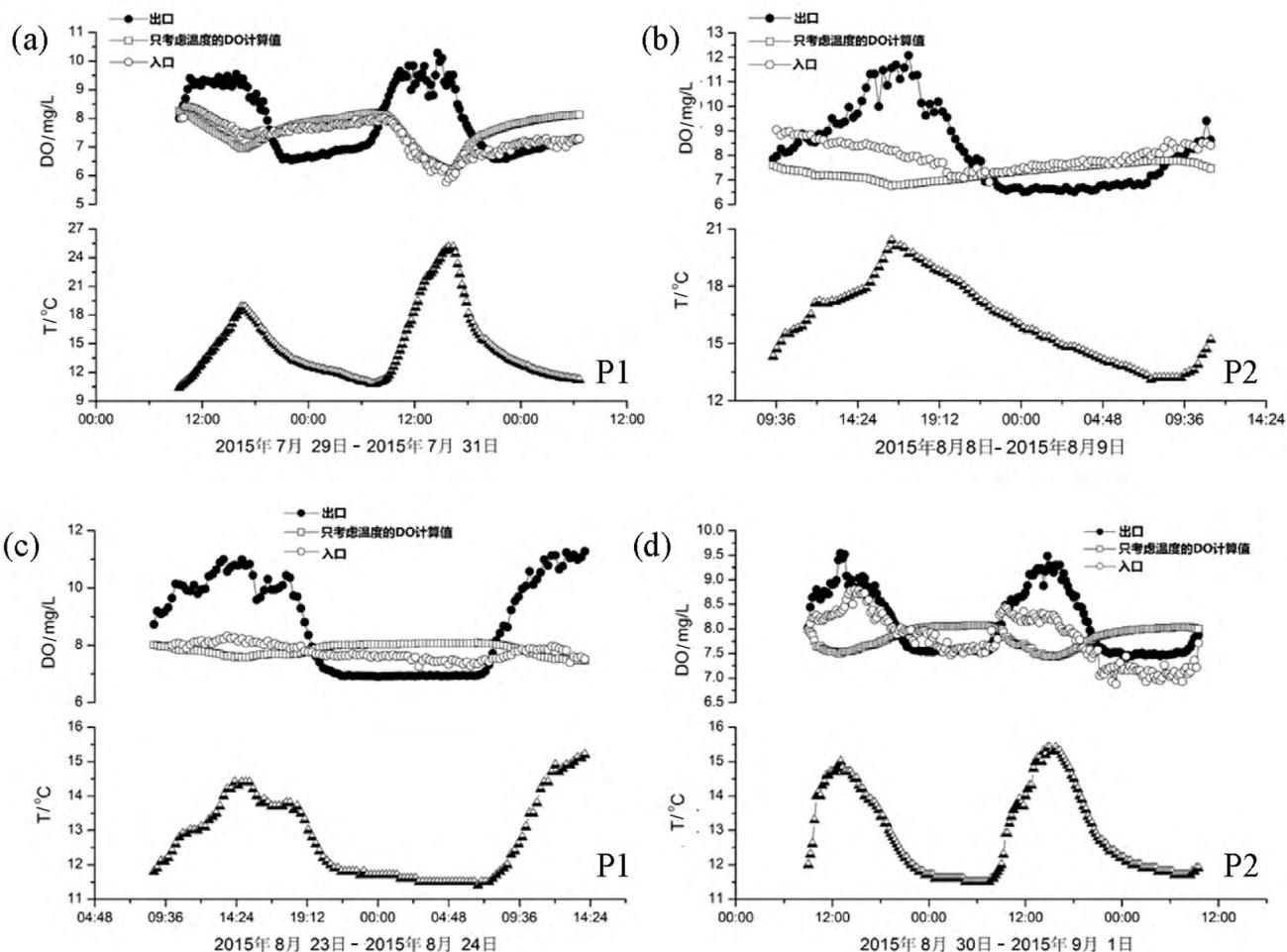
图 7 S1-1 和 S1-3 水体分别补给 P1 和 P2 时出入口实际 DO 的昼夜变化与 DO 计算值的对比
