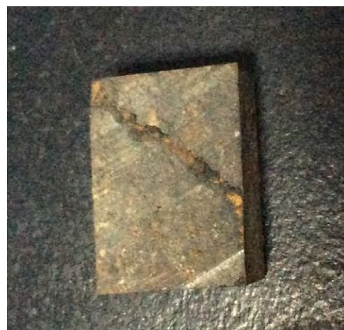
图 5 库姆塔格陨石 8 号测试样品上的裂缝 Fig. 5. Crack on the sample 8 of Kumtag meteorite.
