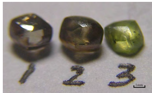
1、2 号样品是同一批次没有经过处理的 I a 型褐色金刚石; 3 号样品处理后呈黄绿色
