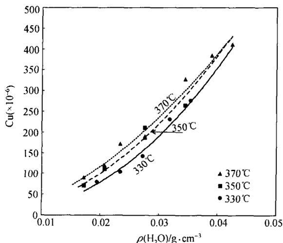
图 4  $\text{CuCl}_2$  在气相中的溶解度与水蒸气密度之间的关系
