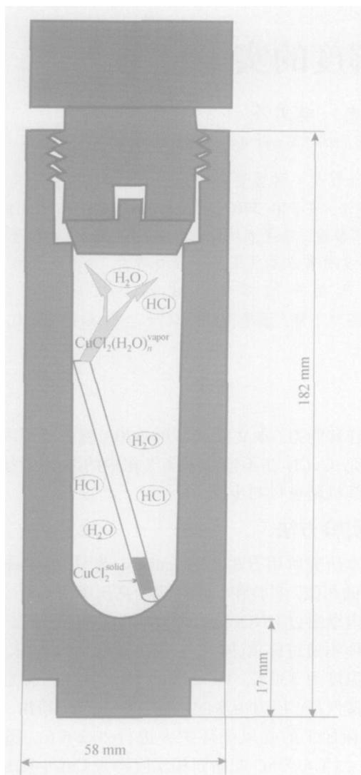
图 1 实验中所用的钛高压釜
