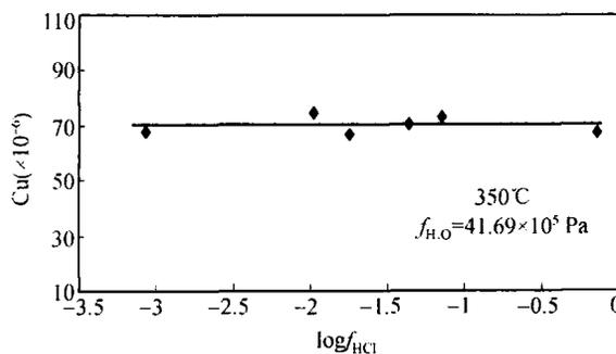
图 3 在气相中的溶解度与  $\log f_{\text{HCl}}$  之间的关系图解
