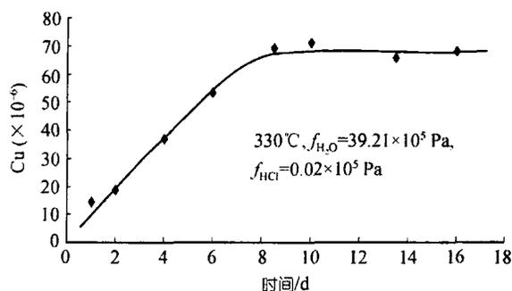
图 2 铜在气相中的溶解度与时间的关系
