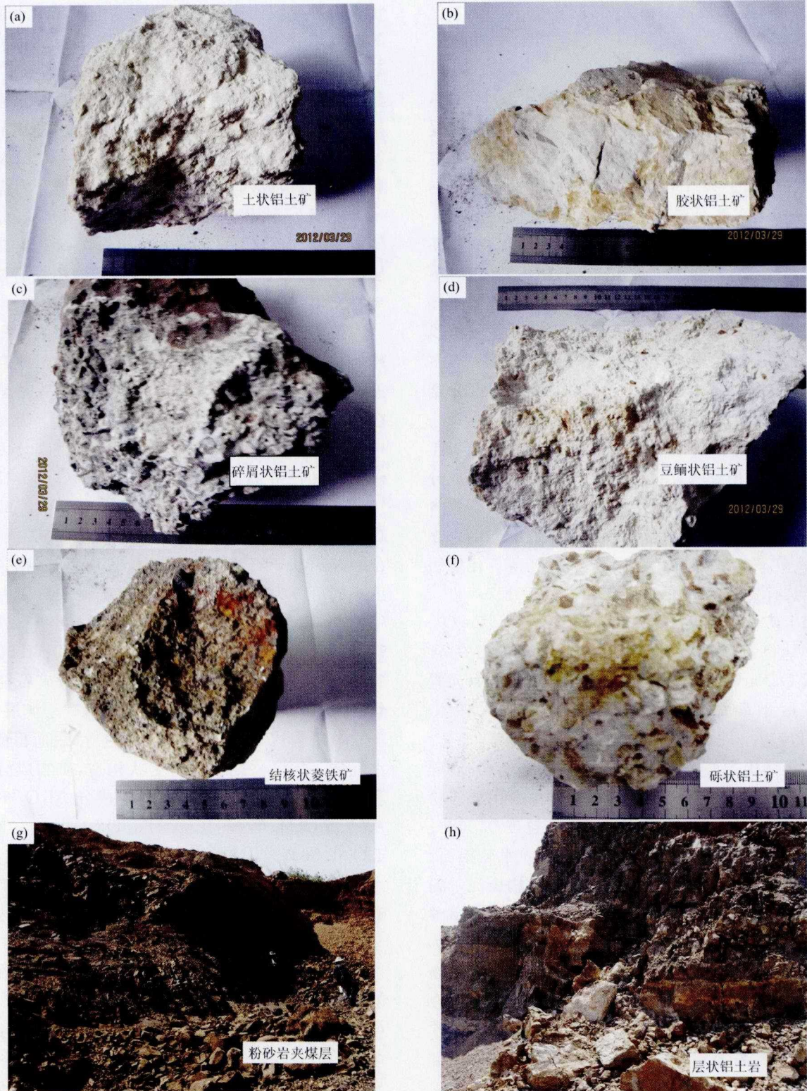
图4 贵州苦李井铝土矿矿石结构构造图(照片中刻度单位:cm)
