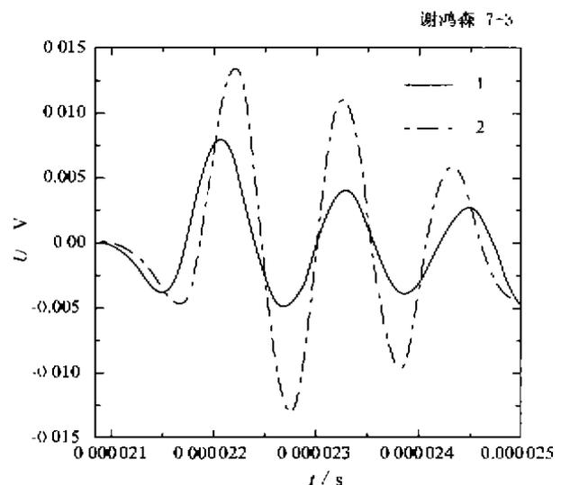
图3 压力为1.0 GPa,温度为641℃(1)和705℃(2)时蛇纹岩的超声波形的振幅比较
