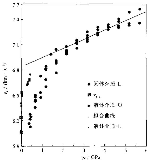
图 1 室温条件下玄武岩不同压力下的纵波波速
