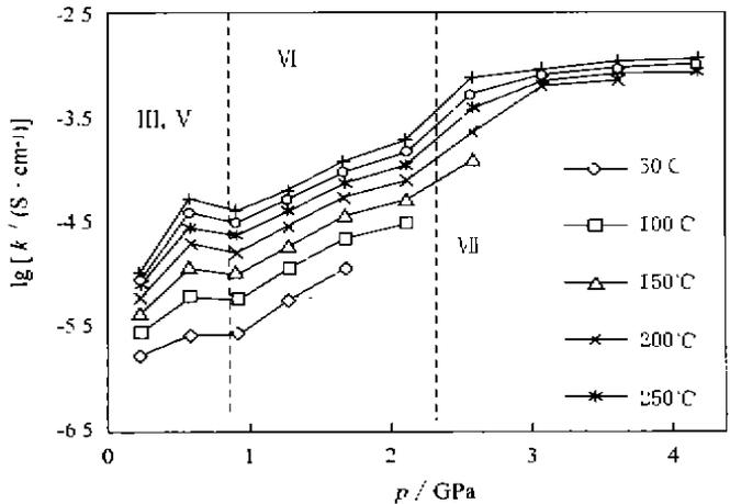
图 6 高温高压下水的电导率
