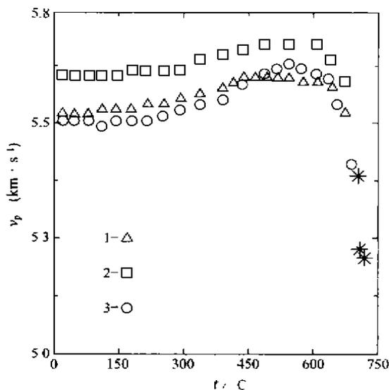
图2 1.0 GPa条件下蛇纹岩纵波速度( $v_p$ )随温度的变化
