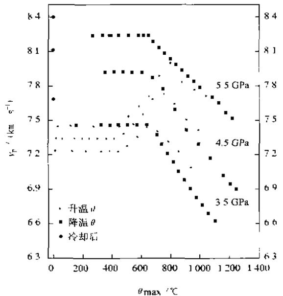
图 4 高于 3.5 GPa 各压力下纵波波速与温度的关系
