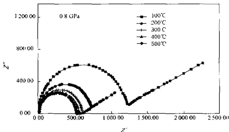
图 7  $0.8 \text{ GPa}$  下  $100 \sim 500^\circ\text{C}$  KCl 溶液的复数阻抗平面图
