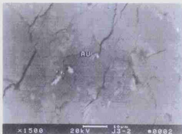
照片3 粉末成型样试验后自然金颗粒(Au)分布在新形成的裂隙中(轴压  $17.5 \times 10^8 \text{ Pa}$ ,围压  $5.4 \times 10^8 \text{ Pa}$ ,温度  $510 \text{ }^\circ\text{C}$ ,时间 12.5h)
