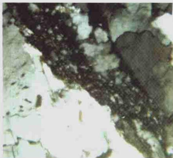
照片1 变形中形成的分布在微剪切带中的碎粒流带逐渐尖灭( $\times 160$ ,正交偏光,轴压  $18.7 \times 10^8 \text{ Pa}$ ,围压  $6.6 \times 10^8 \text{ Pa}$ ,温度  $630 \text{ }^\circ\text{C}$ ,时间 15h)
